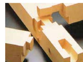
木造建築に用いる柱や梁などの継手や仕口の加工をあらかじめ機械化された工場で行います。建築現場での加工を減らすことができ、工期の短縮やコストダウン、現場廃材の削減につながっています。
